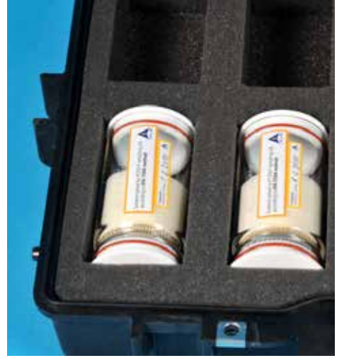
Yarı Uçucu (SVOC) örnekleme kartuşu – ortam havası
