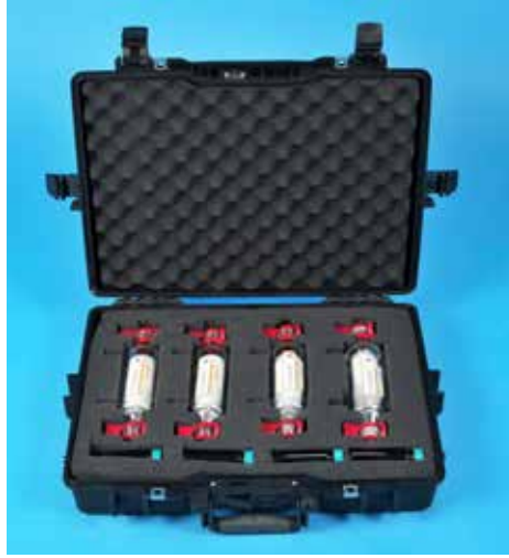
Yarı Uçucu (SVOC) örnekleme kartuşu – PUF
